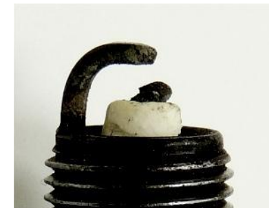
Vzhled zapalovací svíčky při překročení předepsaného utahovacího momentu
