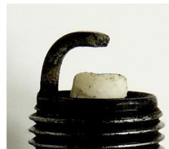
Vzhled zapalovací svíčky při překročení předepsaného utahovacího momentu
